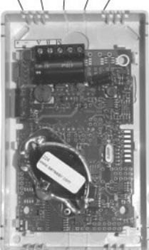
Elektronische print van de CO2 sensor
